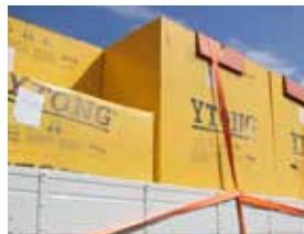
**2** Каждый отдельный ряд поддонов должен быть зафиксирован с помощью натяжного ремня. Ремень закрепляется внутри на предусмотренных для этого креплениях, расположенных на погрузочной поверхности, и натягивается с усилием.
